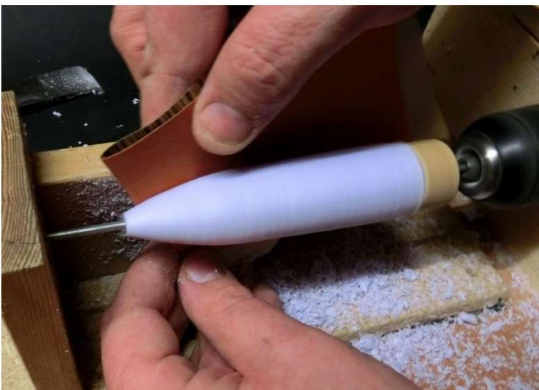
Wenn der Körper einigermaßen glatt ist, mit Stecheisen und Schleifpapier hinten (am dicken Ende) den Posenkörper auch abrunden, so dass ein rundes Ende entsteht:
