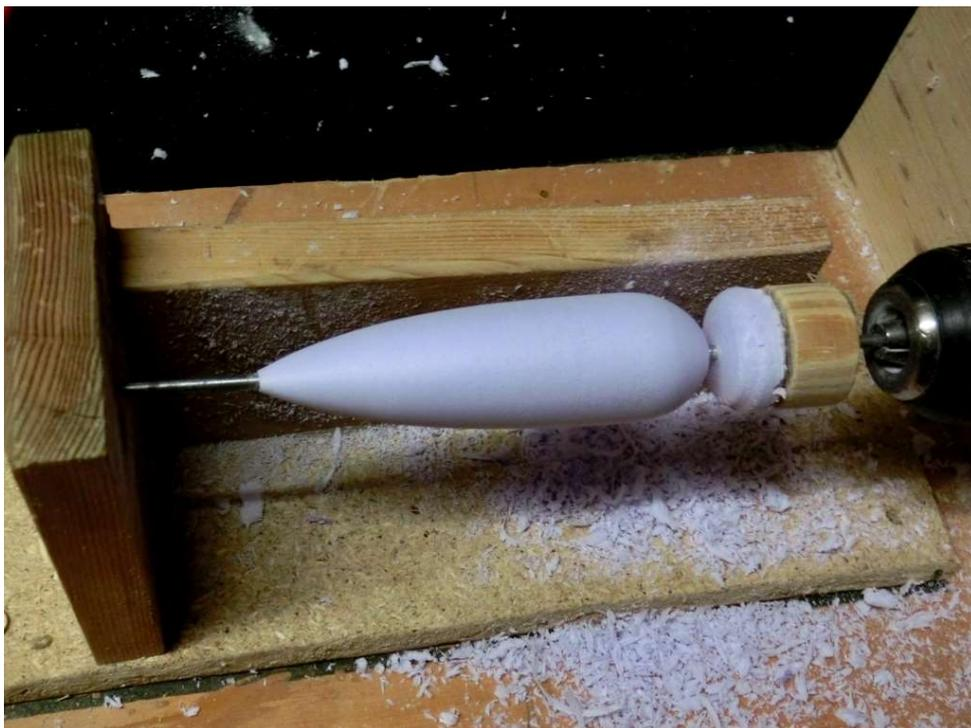
So sollte der fertige Posenkörper aussehen...
