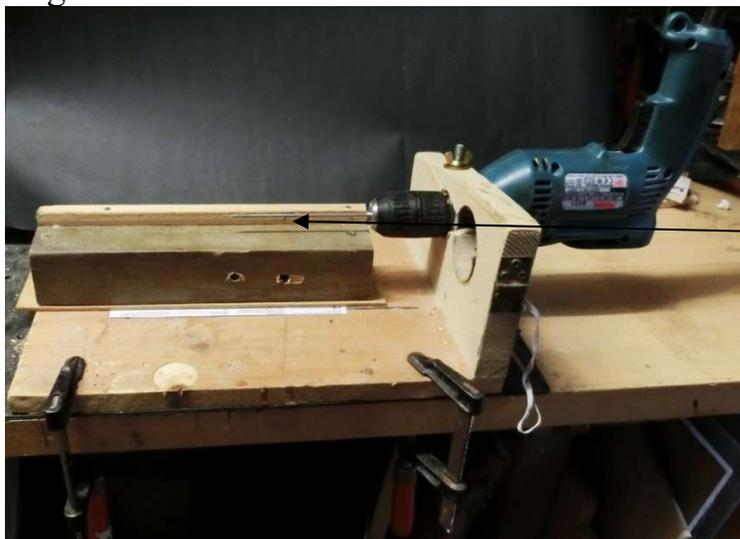
Unsere Bohrmaschinen-Gepowerte Drehbank
