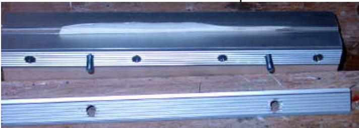
Jetzt die dritte Aluschiene auf die 5 mm Schrauben setzen und bis an den Kiel schieben (Man kann jetzt zur Sicherung die Flügelmuttern drauf schrauben, bei Serienproduktion hab ich es irgendwann sein lassen...)
