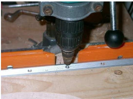
Die Aluleisten mit der glatten Seite nach oben auf die beiden Holzleisten legen und seitlich festschrauben. Die Aussenkante der Aluleiste muss genau mit der Holzleiste abschliessen. Bei Buche empfiehlt sich das Vorbohren mit einem 2 mm Bohrer.
