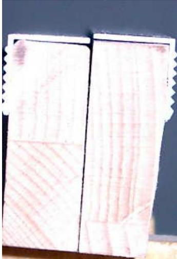
Für das *Feintuning* sind aber einige Probeschneidungen sinnvoll. Dazu legt ihr eine Feder zwischen beide Leisten und richtet diese dann nach eigenem Ermessen aus. Das gesamte Teil in einen Schraubstock gespannt und dann wird mit einem Schabmesser/Cuttermesser o.ä. die Feder bearbeitet. Achtet aber beim Schneiden darauf, zunächst schräg angesetzt von hinten zu schneiden...
