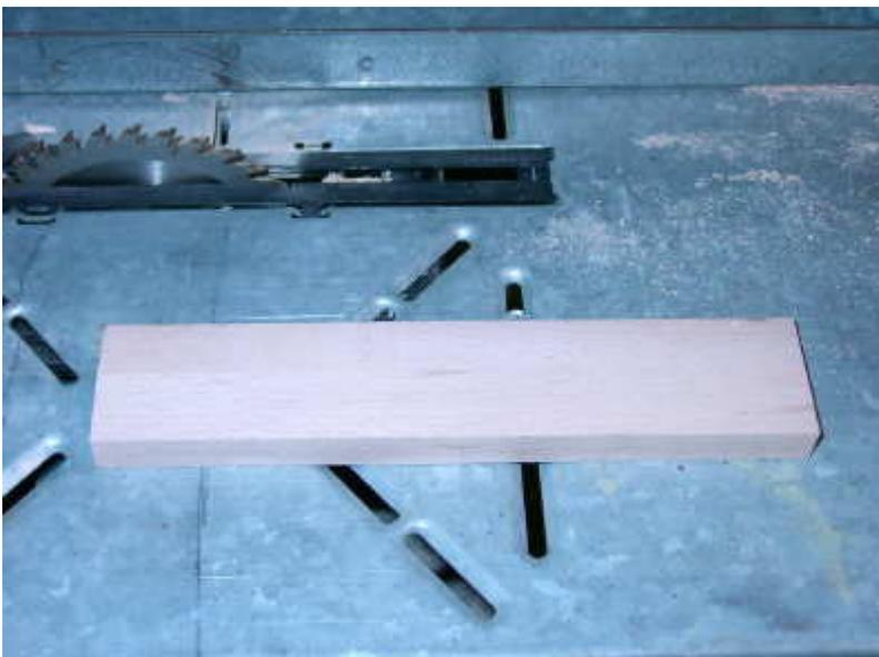
die Kantenleiste auf drei Stücke a´ 25 cm absägen (aus dem Rest lassen sich prima Schablonen für Federn sägen...). In zwei der Leisten werden auf der geriffelten Seite 4 Bohrungen von 3,2 mm gesetzt. Wer will, kann die Löcher mit einem Senker, oder einem Schleifaufsatz verfeinern, damit die Schrauben schön versenkt werden.
