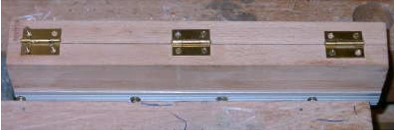
Nun die dritte Aluleiste auf die untere der beiden Seitenteile legen, festspannen und zwei 5 mm Bohrungen durch die Aluleisten und das Holz bohren. Bei Buche müsste auf der Holzseite noch eine 7 mm dicke Vertiefung von ca. 5 mm gesetzt werden, damit die Gewindeschraube auch versenkt werden kann.
