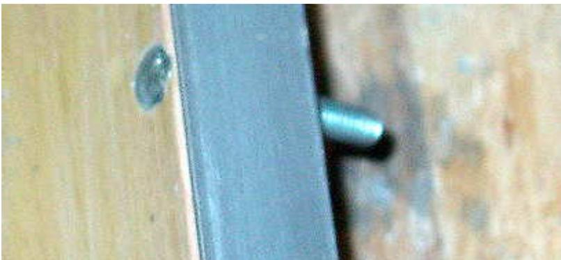
Die dritte Aluleiste jetzt in einen Schraubstock spannen (oder besser das ganze über einen Bohrständler regeln) und die Bohrung quer zur Längsachse um das doppelte vergrößern
