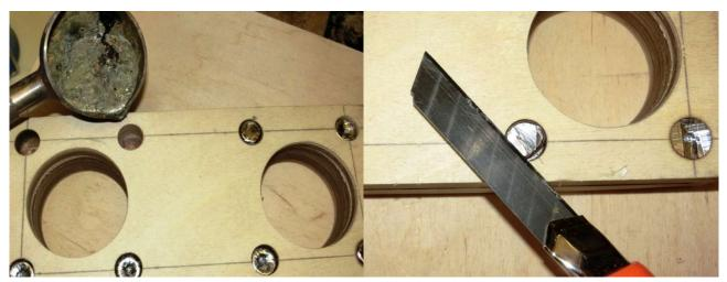
Die Innenränder der Löcher bei Bedarf glatt schleifen (Von Hand oder mit der Maschine) und mit der 9mm starken Sperrholzplatten unten zusammenleimen
