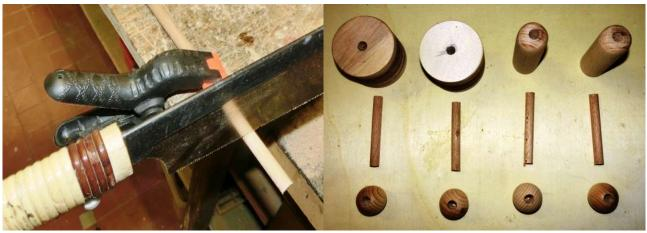
Zunächst die 8 mm Rundstäbe in die Zylinderkörper einleimen
