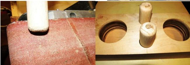
Mit dem 35 mm Forstnerbohrer mittig ein ca. 20 mm tiefes Loch in die Zylinder bohren, ebenso in die Schächte der Basis, dort aber ruhig durchbohren.
