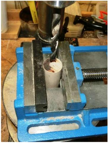
Von der Unterseite her mittig mit dem 8 mm Holzbohrer ein Loch für den "Hals" durchbohren. Die obere Seite mit Raspel/Bandschleifer abrunden.
