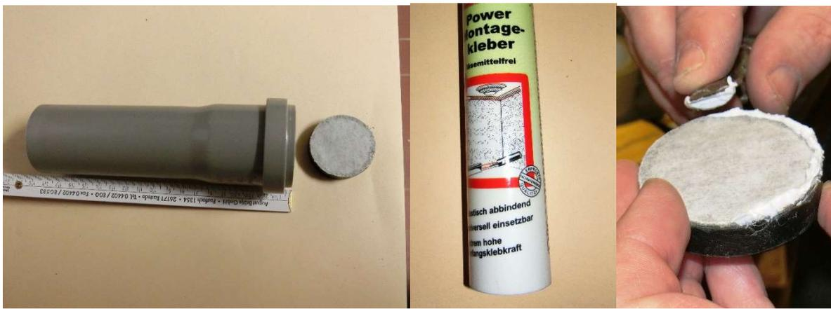
Das Rohrstück auf der Anschlußseite in das große Stück HT-Rohr kleben (halt da, wo man das haben möchte). Damit hätten wir auch die Membran fertig. Dann noch das HT-Rohr auf den HT-Winkel stecken. Im Grunde genommen könnte man das Fluidbed jetzt schon in Betrieb nehmen, wenn man den Schlauch an den Eingang in das Fluidbed und
