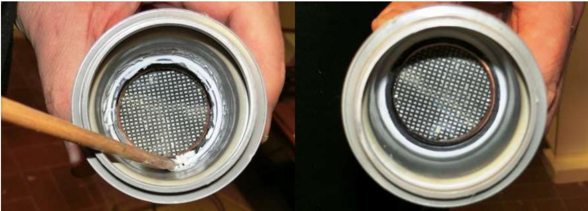
So siher dann ein fertiges Rohr mit Membran für das Pulver aus. Es ist ratsam, die Schwarze Dichtung mit Vaseline o.ä. einzustreichen, da man sonst das Rohr echt schwer wieder von der Luftkammer (dem Winkelstück) abbekommt, wenn man mit Wechselrohren arbeiten will.
