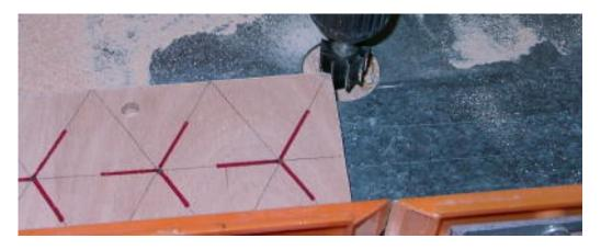
Jetzt werden die Schablonen entsprechend der späteren Schaftstärke an den Markierungsbohrungen auf den richtigen Durchmesser gebracht. Für 5/16 Schäfte -> 8,5 mm Für 11/32 Schäfte -> 9,5 mm
