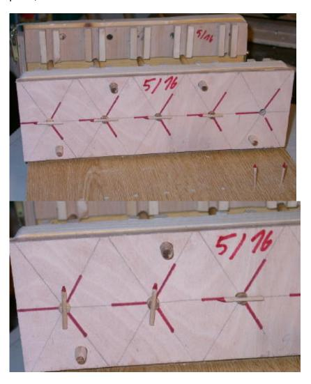
Man kann die Klammern auch noch fixieren, aber bei meinem Gerät passten die so gut, dass eine Fixierung nicht mehr notwendig war. Nachdem die ersten Federn geklebt sind, Klammern zusammendrücken und nach oben ziehen, Markierungen auf die nächste Einstellung und das Ganze von vorne!
