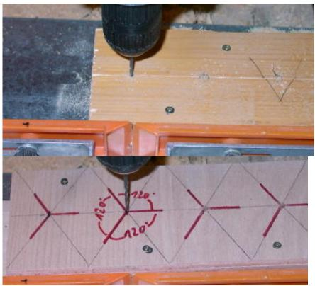
Anschließend die Holzschrauben einzeln lösen und jeweils nach dem Lösen eine 8mm-Bohrung durch alle drei Bretter setzen. Jedes Loch sofort mit einem Holzdübel fixieren – **aber noch nicht fest leimen**
