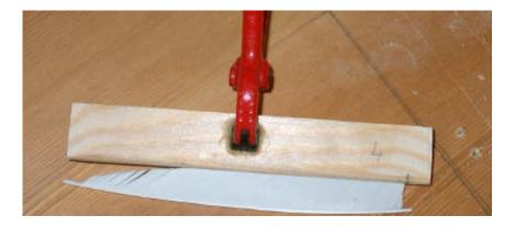
Jetzt werden beiderseits der Löcher für die Schäfte die 7 mm Leisten angebracht und mit Holzleim befestigt. Zur Hilfe kann man die jeweilige Klammer als Maßstab für die Zwischenräume nehmen!
