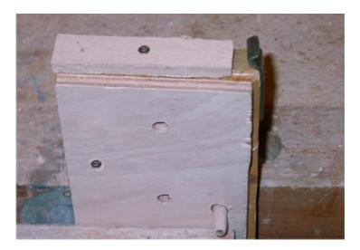
Auf dieses Reststück wir der Kistenverschluss mit 10 mm langen Schrauben verschraubt. Man kann auch längere Schrauben nehmen, muss diese aber entsprechend bis auf das Reststück abfeilen/-schleifen. (Sonst könnte man die entstandene Klappe nicht öffnen).
