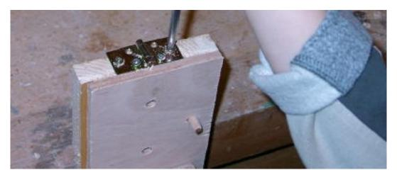
Auf der anderen Seite wird jetzt ein kleines Reststück von dem Sperrholz geschraubt, da sonst der vorhandene Kistenverschluss nicht gepasst hätte.
