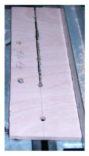
Die **geteilte** Seitenwand jetzt mit entsprechenden Vorbohrungen mit vier Schrauben (4 x 35 mm) an den linken Rand der Bodenplatte schrauben und die beiden Schablonen (in diesem Fall eine für 5/15 Schäfte und eine für 11/32 Schäfte) anpassen.
