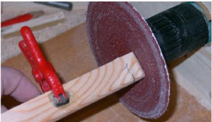
Für die Bestimmung der richtigen Stärke der Klammern an den Enden gilt das Gleiche. Dazu zunächst eine Feder in die Klammer spannen und dann die Klammer an den Enden auf beiden Seiten so lange schleifen, bis sie jeweils genau in die Halterung passt. Damit das auch immer passt, habe ich Klammer und Halterung jeweils numeriert.
