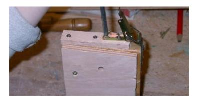
Um den Schäften einen entsprechenden Halt zu geben, habe ich die getrennte Seitenwand an den Markierungsbohrungen mit Bohrungen versehen, 8,5 mm für die 5/16 Schablone und 9,5 mm für die 11/32-Schablone.
